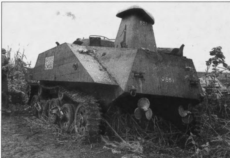
Танк «Ка-ми», подбитый на о. Лусон в январе 1945 года. Понтоны сбрасывались по выходу машины на берег. На снимке хорошо видны гребные винты
