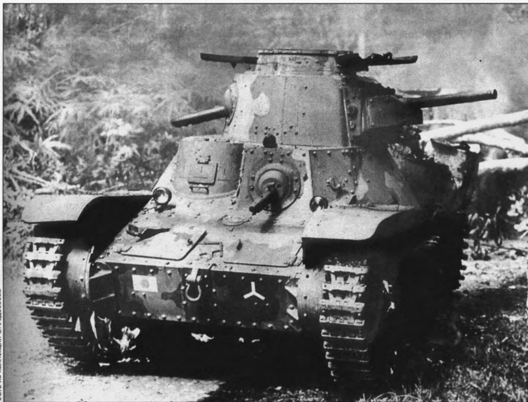
Горящий «Ха-го». На фото хорошо просматриваются броневые кожухи пулеметов. Филиппины, 1944 год
