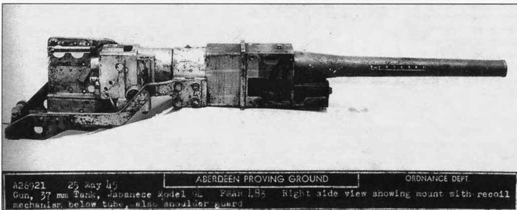
37-мм пушка Тип 94. Фото из отчета Абердинского полигона, 1945 год
