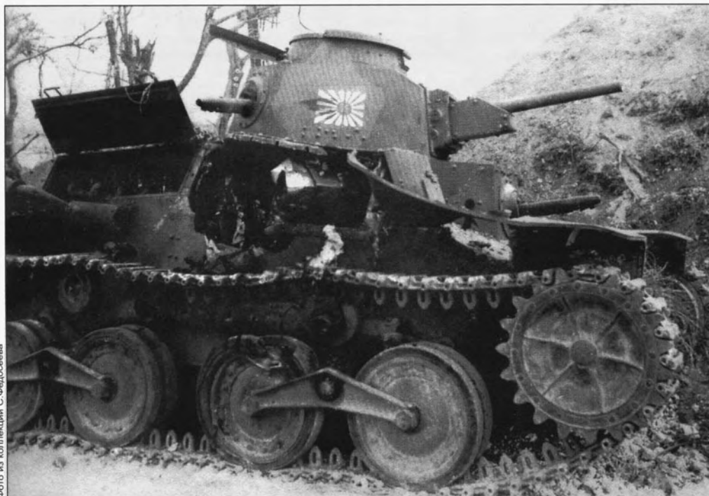
Танк «Ха-го» из состава 4-й роты 9-го японского танкового полка. Эта машина получила попадание снаряда, выпущенного из танка М4А2 2-го танкового батальона морской пехоты США. Сайпан, июнь 1944 года
