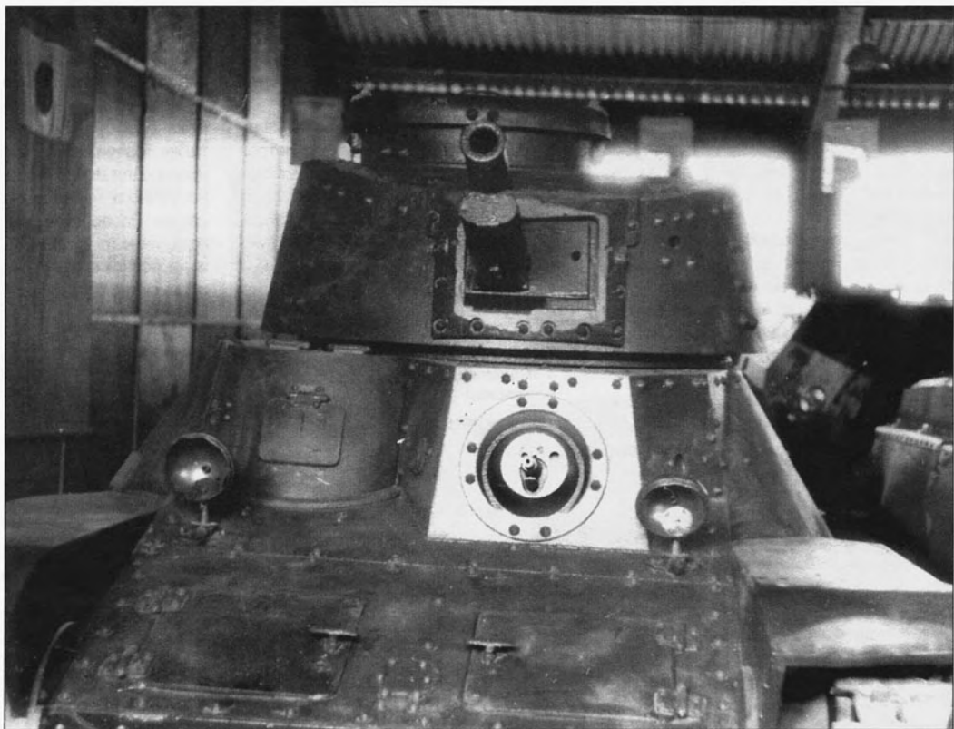
Легкий танк Тип 3 «Ке-ри» внешне отличался от «Ха-го» только башней, заимствованной у среднего танка «Чи-ха»
